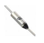
**SDF DF152S** Cantherm TCO 250VAC 10A 152C(306F) AXIAL
