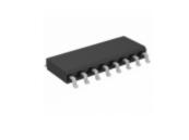
M74HC257RM13TR STMicroelectronics IC MULTIPLEXER QUAD 2CH 16-SOIC
