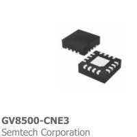
IC TRANSMITTER 16QFN
