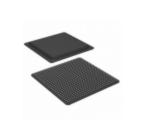
XC3S2000-5FGG676C Xilinx Inc. IC FPGA 489 I/O 676FBGA
