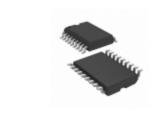
LT1180AISW#TRPBF Linear Technology IC DRVR/RCVR RS232 5V DL 18SOIC
