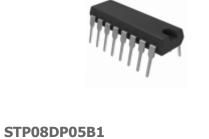
STMicroelectronics IC LED DRIVER LINEAR 100MA 16DIP
