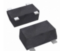
CE3514M4-C2 CEL RF MOSFET PHEMT FET 2V SOT343
