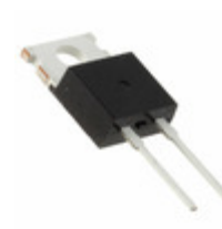
DSEP29-03A IXYS DIODE GEN PURP 300V 30A TO220AC
